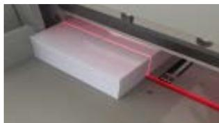
Luz de corte "LCD" para fácil visualización y precisión en la zona de corte
